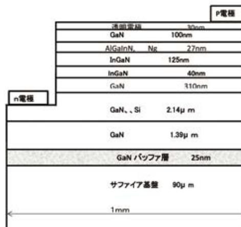
図5 LEDチップの層構造
